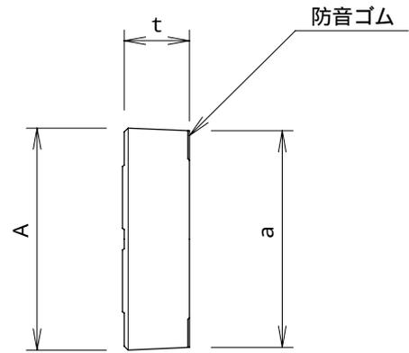
落蓋側溝 縦断用蓋版 寸法表
